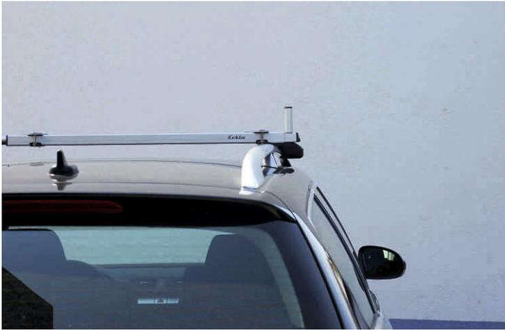
Beim ein- und ausfahren des Ladearms, bitte unbedingt darauf achten, dass der Verriegelungsknopf in der eingefahrenen bzw. ganz ausgefahrenen Position, immer eingerastet ist !.
