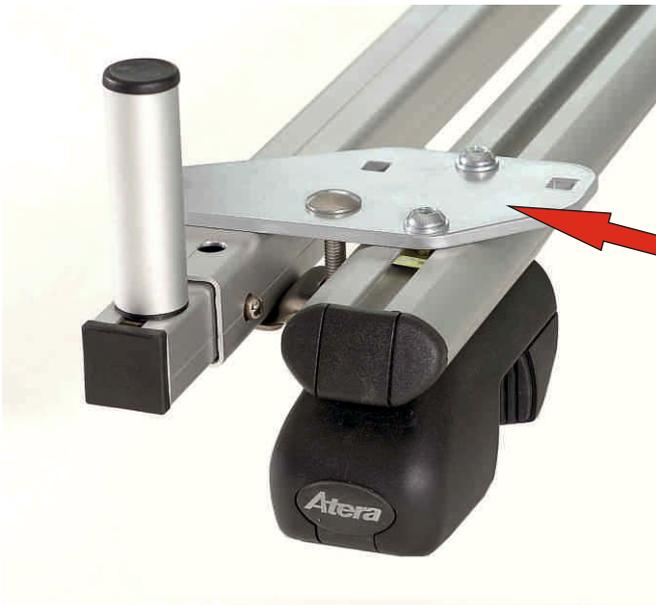
Hier die Schrauben für T-Nutensysteme verwenden
